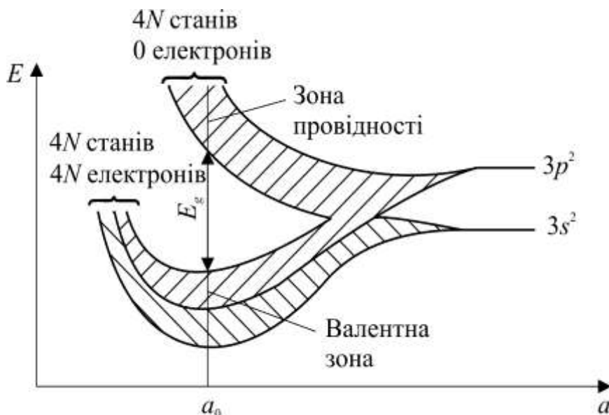
Рис. 8.3. Розщеплення валентних рівнів кремнію і утворення енергетичних зон (порівняйте із зонами металів – натрію, рис. 3.23 і міді, рис. 3.24)
