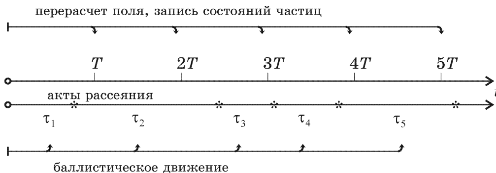
Рис. 1.4. Характерные временные моменты в многочастичном методе Монте-Карло: шкала моментов пересчета поля и записи состояний частиц и шкала моментов актов рассеяний, между которыми моделируется свободное движение частиц.
