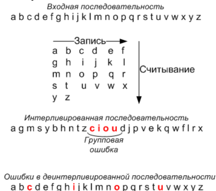
Рис. 2. Принцип роботи блокового інтерлівера.
