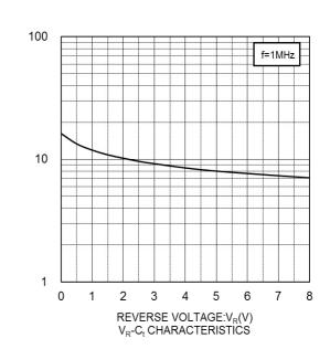
CAPACITANCE BETWEEN TERMINALS:C<sub>t</sub>(pF)
