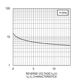
CAPACITANCE BETWEEN TERMINALS:C<sub>t</sub>(pF)
