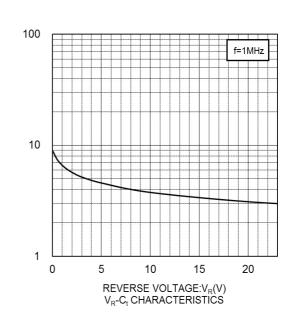
CAPACITANCE BETWEEN TERMINALS:C<sub>t</sub>(pF)
