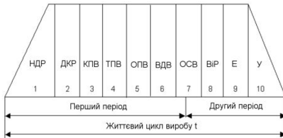
Рис. 1. Життєвий цикл міроелектронної апаратури.
